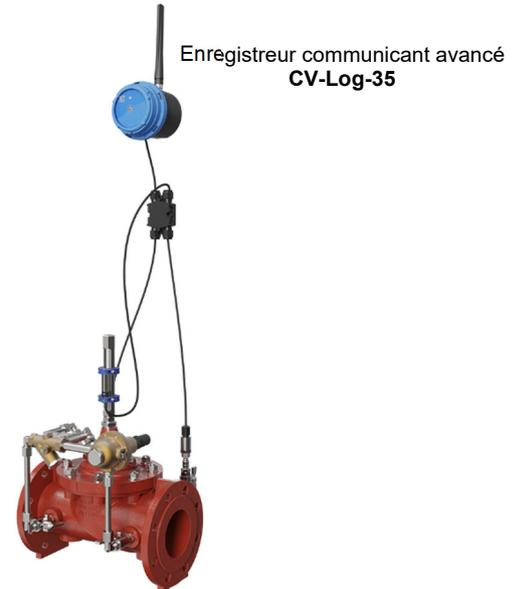
La SERIE CLA-VAL 90 COM de vannes de stabilisation de pression aval permet une intégration clé-en-main aux systèmes de gestion d'eau intelligents. Elle contient un enregistreur multi-canal communicant avancé CLA-VAL CV-Log-35, embarquant un algorithme de calcul de débit, permettant la gestion et la supervision à distance des pressions amont/aval, des débit et volume d'eau, et de l'ouverture de la vanne.
