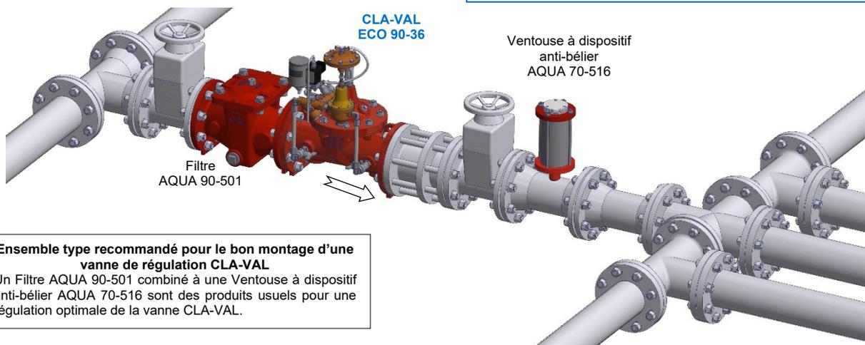
**Ensemble type recommandé pour le bon montage d'une vanne de régulation CLA-VAL**
