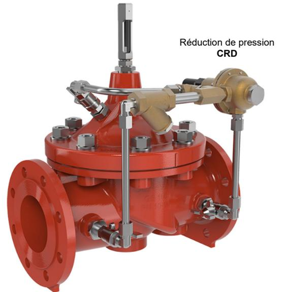
La SERIE CLA-VAL 90 réduit la pression amont variable en une pression aval inférieure et constante sans égard aux fluctuations de débit et/ou de pression amont.
