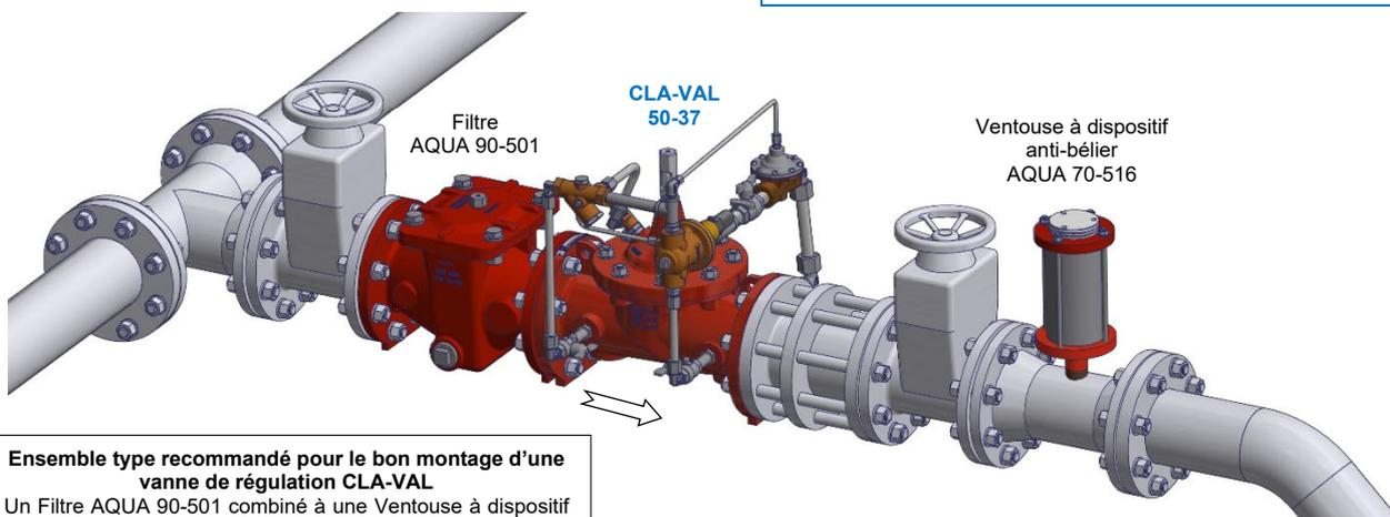
**Ensemble type recommandé pour le bon montage d'une vanne de régulation CLA-VAL**
