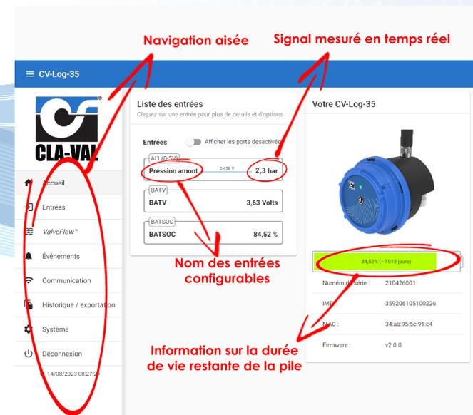
L'enregistreur **CLA-VAL CV-Log-35** intègre une pile au lithium standard permettant une autonomie de 5 ans\*. La durée de vie peut être prolongée grâce à une pile externe de grande capacité disponible en option.
