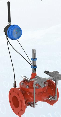
**ValveFlow™** calcule automatiquement le débit passant au travers d'une vanne CLA-VAL avec une précision moyenne de 4 % relative à la valeur lue, fournissant des informations sur le débit dans les endroits où aucun débitmètre n'est disponible, ou permettant un meilleur diagnostic en comparant le calcul **ValveFlow™** à un débitmètre de référence.
